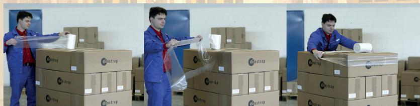
Ziehen Sie Sanstrap® von der Rolle. Trennen Sie das Dehnband an der Perforationsnaht ab
