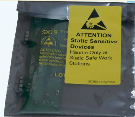
**Abschirmende Verpackung** sind laut DIN EN 61340-5-3 die universelle Verpackung für den Transport von elektronischen Komponenten (ESDs) außerhalb der ESD-Schutzzone (EPA).
