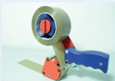
Handabroller max. RollenØ170mm, verdecktes Messer, einstellbare Rollenbremse, zwei Anpressrollen, Klingensabzug zum Auslösen eines Messers
